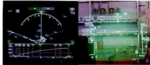
五つあるモニターの一つ。cockpit(左ページ写真)の中央右側のディスプレイを拡大した写真。画面の下3分の1に表示されているのは、飛行機がこれから飛行する高度の情報。このような垂直(鉛直)方向の情報を表示するのは、B787がはじめてだという。
