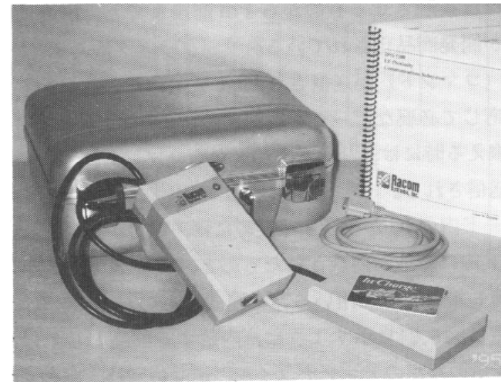
図 6.25 非接触カードシステムの例
