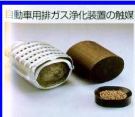
自動車用排ガス浄化装置の触媒
