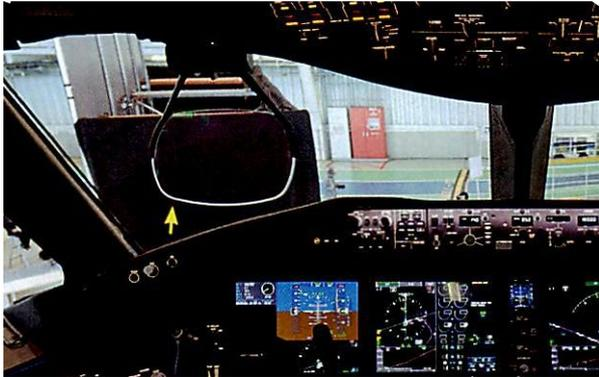
B787のcockpit。両側の席ともにヘッドアップ・ディスプレイ(写真中の矢印)がつけられた。B787がはじめてだ。中央の五つのディスプレイはそれぞれ切りかえることができ、一部が故障して使えなくなってもほかで代用が可能だ。操縦桿(コントロールホイール、座席正面)を前後に押し引きすることで機首の上下(水平尾翼のエレベーターを動かす)を、左右にまわすことで機体の傾き(旋回するときの動き、主翼のエルロンなどを動かす)を制御する。足下のペダルでは、機首の左右(垂直尾翼のラダーを動かす)を制御する。写真は2011年9月28日に羽田空港に到着した初号機を撮影。
